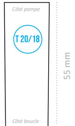
Pour ce modèle la largeur est réduite de 2 mm au niveau de la boucle de montre (largeur de 18 mm).
