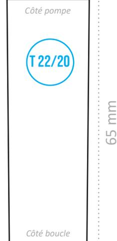
Pour ce modèle la largeur est réduite de 2 mm au niveau de la boucle de montre (largeur de 20 mm).
